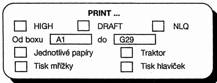
Nejprve zadejte kvalitu tisku (HIGH/DRAFT/NLQ), ale chcete-li tisknout ve vysoké kvalitě (NLQ), musíte mít též odpovídající ovladač tiskárny, který je přizpůsoben pro tisk v NLQ.
