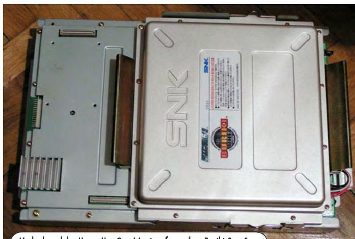
Motherboard des Hyper Neo Geo 64 mit aufgesteckter Buriki-One-Cart.
