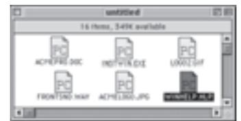
Erkennt: Dateien von einem PC-Medium werden mit der „PC“-Kennung angezeigt.
