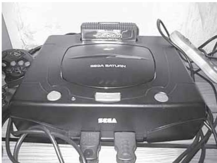
Eine europäische Saturn-Konsole mit einem Action Replay im Modulschacht.
